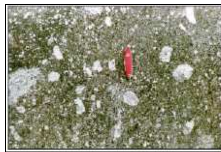
Fig. 8b. Granodiorito porfírico, com megacristais de feldspatos. São Luiz do Anauá. Fonte: CPRM (2000).
