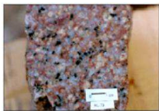
Fig. 17b. Biotita sienogranito róseo com textura eqüigranular média. BR-174. Próximo a vila Vista Alegre. Fonte: CPRM (2000).
