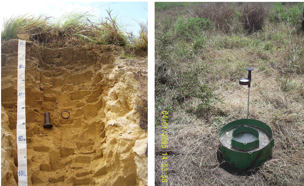
Figura 22 – Perfil de PA mostrando a profundidade do horizonte coeso, entre 30 a 60 cm e os equipamentos usados nos testes de campo (anéis infiltrômetros e penetrômetro).
